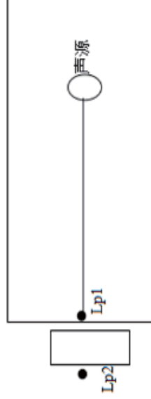
图 4-10 室内声源等效为室外声源图例
